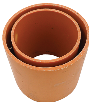
Inderrør til infiltrationsundersøgelse (Ø 160mm.)
