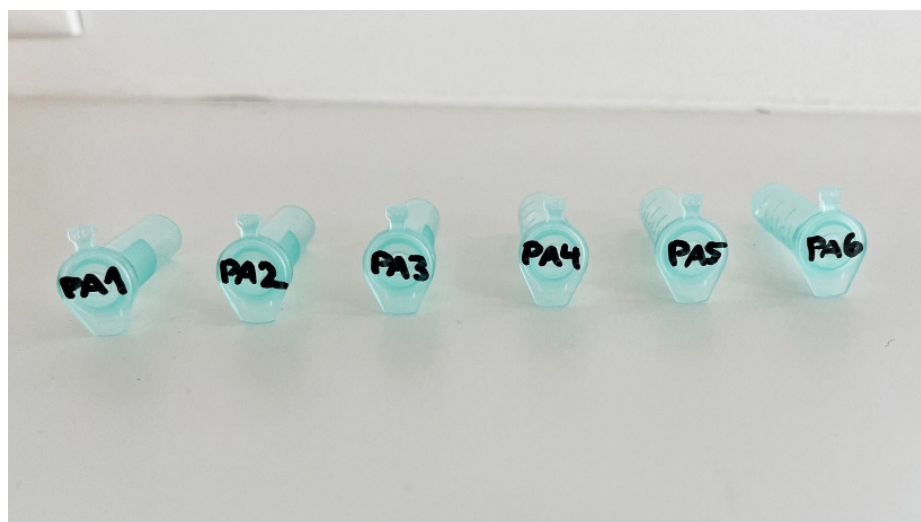
Sådan skal de grønne rør mærkes. Trinnet gentages, så der mærkes i alt 10 grønne rør. © LIFE, 2023
